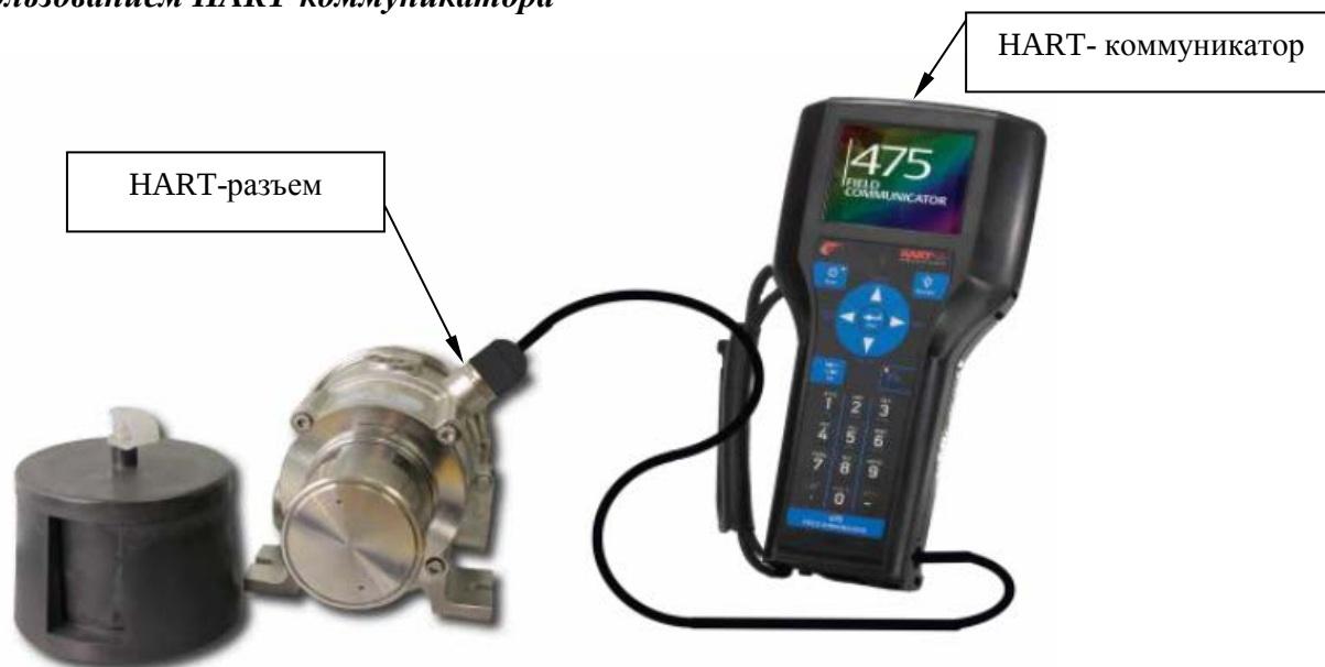
Рисунок 13 – Газоанализатор СГОЭС-М11, подключенный к HART-коммуникатору
