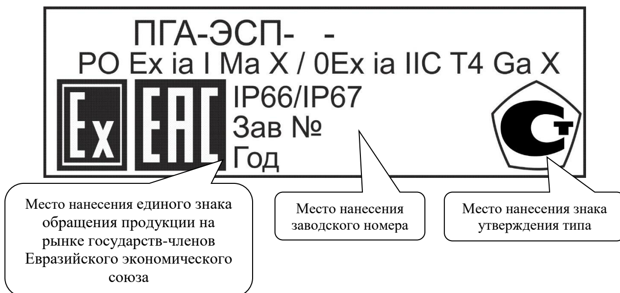
Рисунок 3 – Общий вид таблички с указанием места нанесения заводского номера и знака утверждения типа
