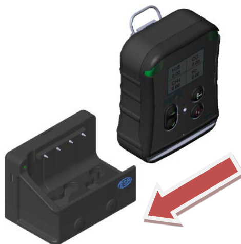
Рисунок 17. Установка прибора в USB-Адаптер
