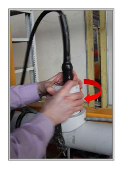
Необходимо убедится, что корпус электронного блока обработки данных невозможно вытащить вертикально. Допускается лёгкое подпружинивание датчика.
